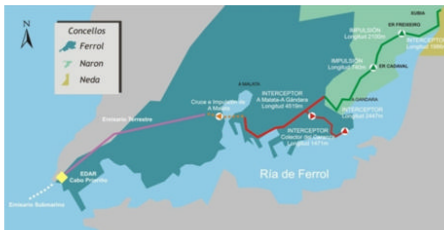
Esquema general de la “Conducción de aguas residuales, depuración y vertido de Ferrol”
